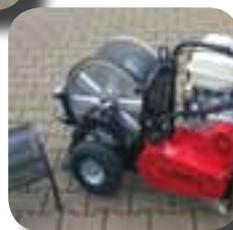
Die Zugkraftmessung erlaubt die Darstellung der aktuellen Zugkraft und ermöglicht durch den Grenzwertsignargeber ein automatisches Abschalten der Winde bei Überschreitung einer vordefinierten Zugkraft.
